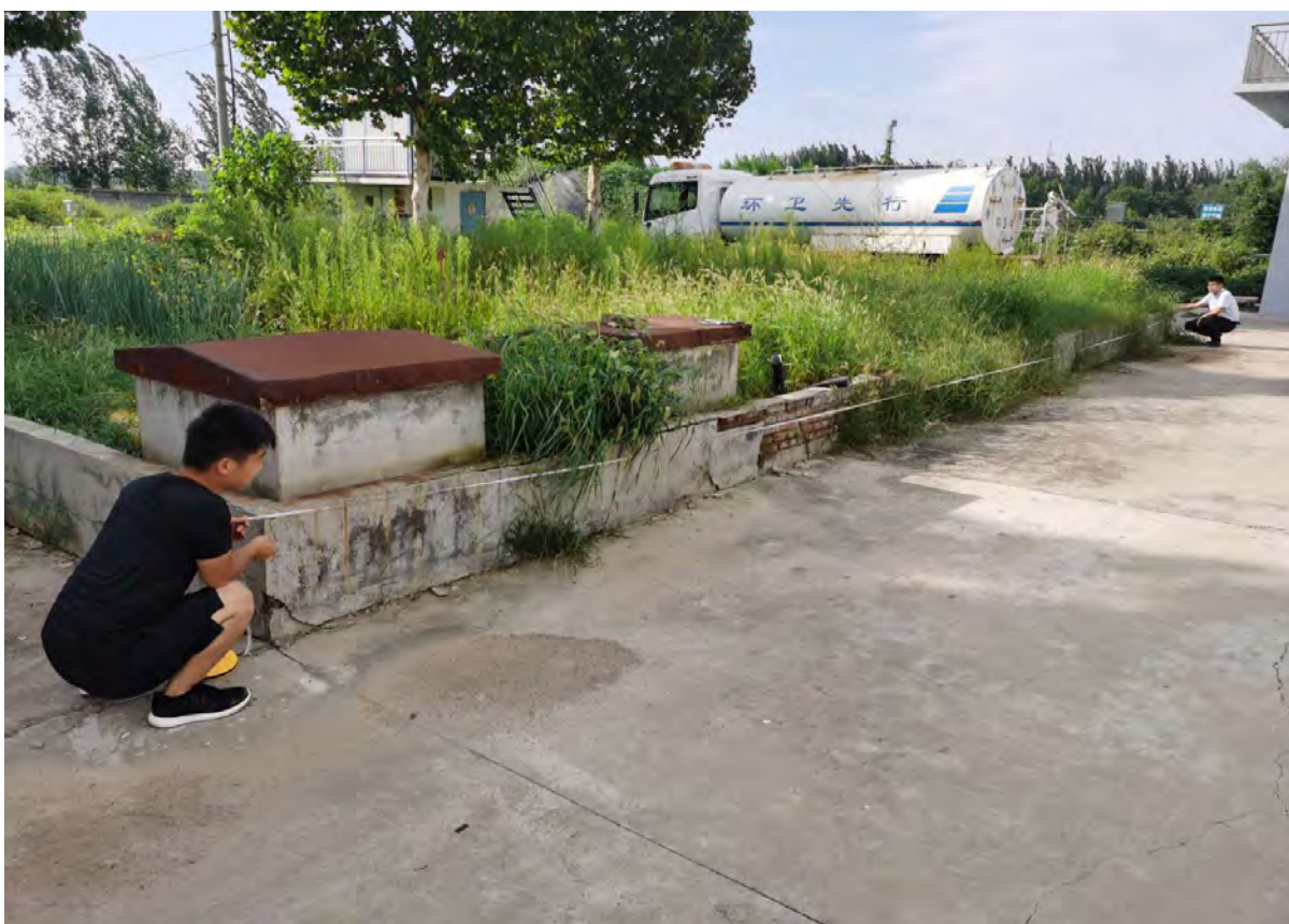
预留建设区集雨池规格测量
